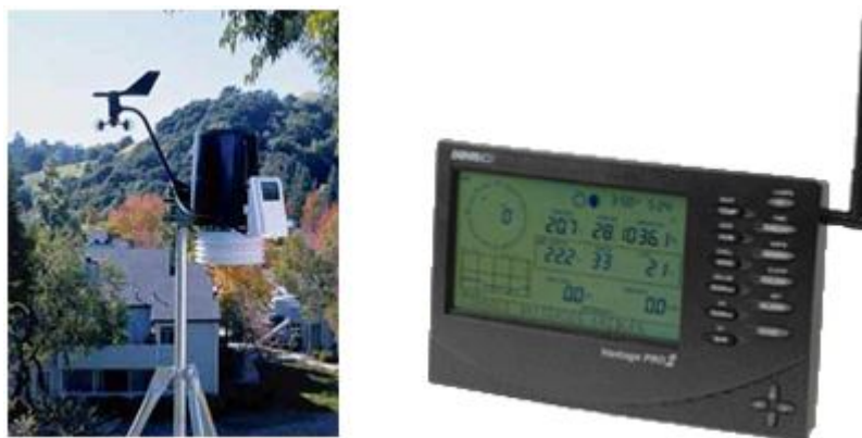
Figure 11 : station de mesure autonome de données météorologiques
