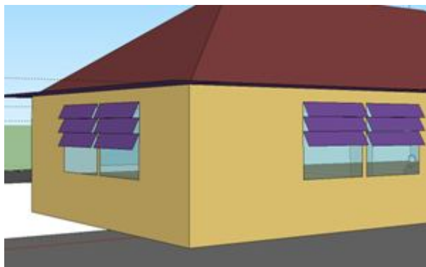
Figure 25 : représentation schématique des brises soleil constitués de 3 lames orientables de largeur 30 cm inclinées ici à 30° par rapport à la verticale.
