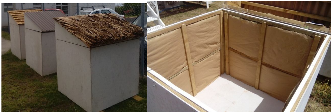
Figure 58 : cellules expérimentales d'essai de nouveaux matériaux
