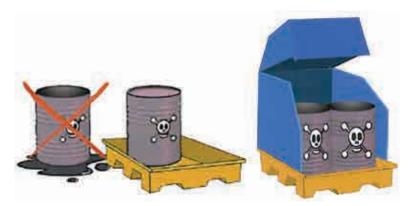
Stockez vos batteries et filtres à huile **séparément** dans des containers **étanches résistants**, afin d'éviter tout rejet d'acide et d'huile usagée. **Couvrez ces bacs** pour ne pas augmenter les volumes à éliminer avec de l'eau de pluie.
